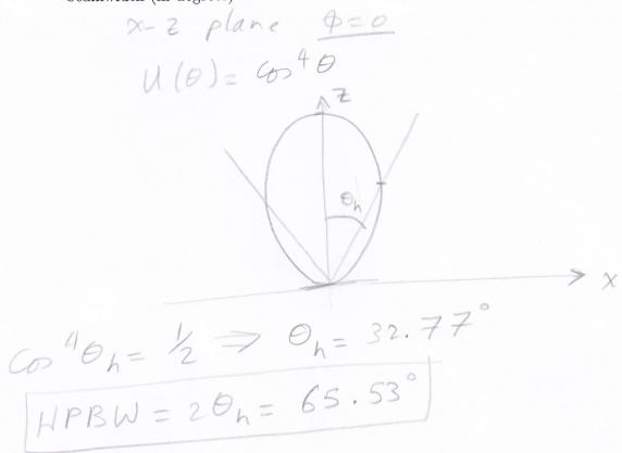
(d) (2 points) Sketch the radiation pattern in elevation y-z plans
